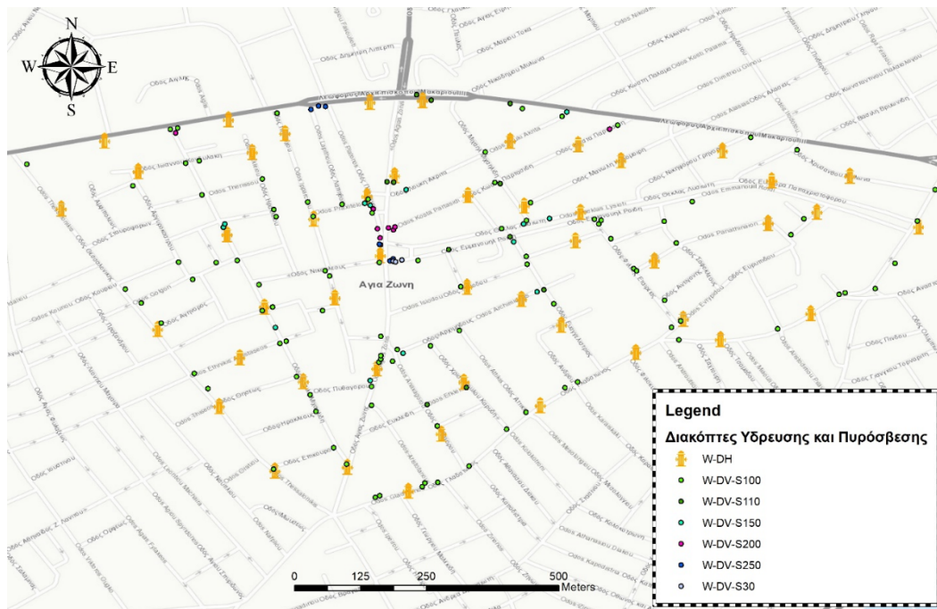
Εικόνα 7: Διακόπτες ύδρευσης και πυρόσβεσης
