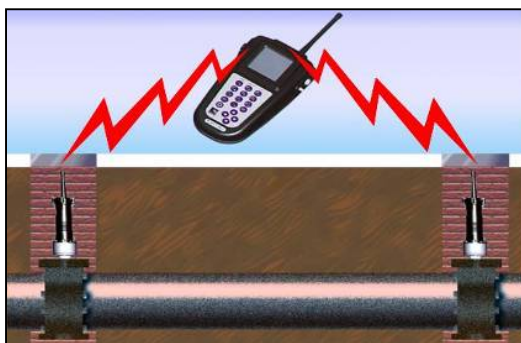
Εικόνα 5: Σχηματική παράσταση επικοινωνίας ραδιοσυχνότητων μικρής εμβέλειας
