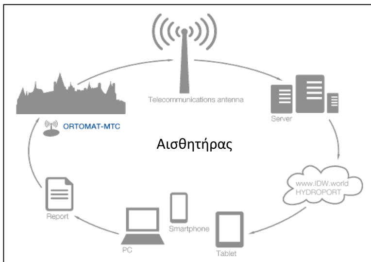
Εικόνα 6: Σχηματική παράσταση επικοινωνίας μέσω GSM/GPRS
